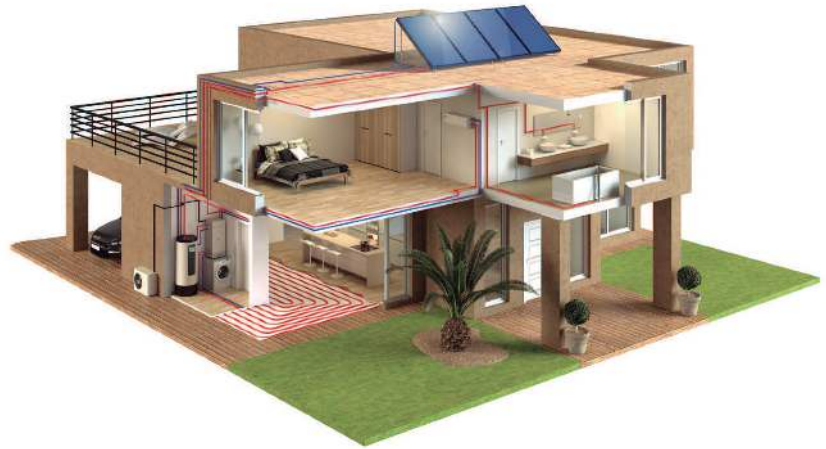
FOTO: SISTEMA AQUATERMIC BOMBA DE CALOR SPLIT, CON APLICACIÓN DE CALEFACCIÓN, REFRIGERACIÓN Y ACS, EN COMBINACIÓN CON SISTEMA DE ENERGÍA SOLAR TÉRMICA.
